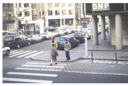
marciapiede avanzato su entrambe le strade per favorire la visuale
