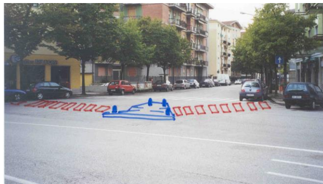
Caso 5b) - La strada esageratamente larga che a senso unico impone di inserire una adeguata isola salvagente centrale e possibilmente avanzare i marciapiedi riordinando i parcheggi
