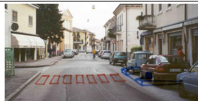
Caso 1b) - La presenza permanente di auto in sosta impone di avanzare il marciapiede dal lato destro
