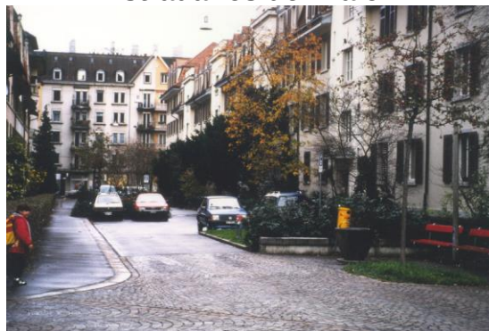
Svizzera, Zurigo, la riorganizzazione delle aree destinate alla sosta delle autovetture, l'utilizzo del verde, gli inserti di pavimentazione realizzati in masselli di calcestruzzo e l'arredo urbano, trasformano l'aspetto della strada
