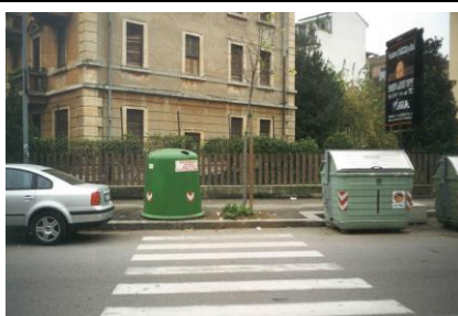
attraversamento pedonale ostruito, senza rampetta e senza visuale
